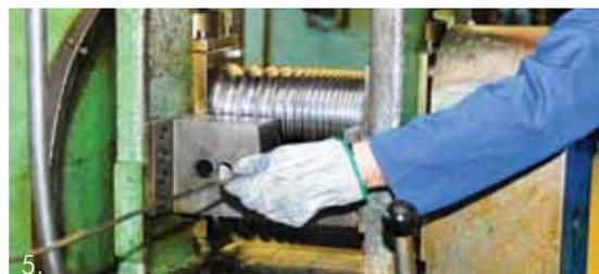
4. Cev z vstavljenim železom najprej valjamo v žico (slika 5) in nato še vlečemo skozi profilno matrico (slika 6). Polovico količine je treba še kotirati (zaviti žico). Ta del postopka traja osem ur.
