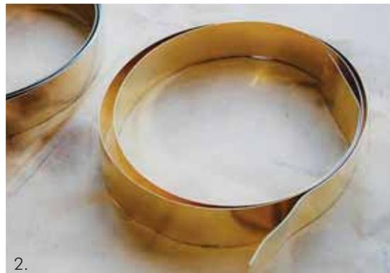
2. Sledi valjanje traku v ploščat trak, kar traja z vsemi vmesnimi žarjenji tri ure (slika 2).
