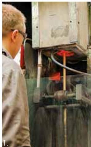
1. Za izdelavo ploščatega traku, odlitega v peči za kontinuirano litje, je minimalna količina za topljenje 1500g zlata čistine 585/000 (slika 1).
